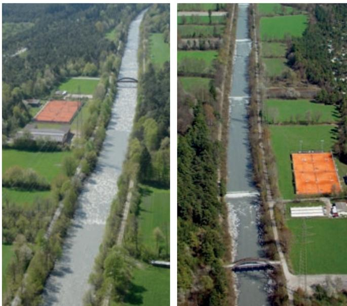
Seit 2009 wurden die damals in der Landquart befindlichen Sohlswellen (rechts) aufgelöst und durch raue Rampen (links) ersetzt. Dies erhöht die Durchgängigkeit für Fische aus dem Alpenrhein in die Landquart.
