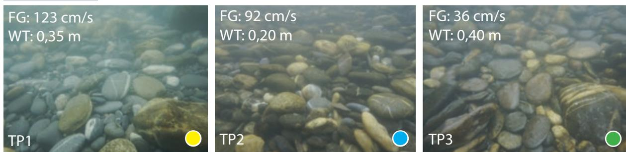
Abb. 104: Mittels UW-Sampler beprobte Teilflächen (Teilproben 1-3). TP1-3 = Teilproben; WT = Wassertiefe. Kolmationskategorien: Stufe 1 = ● keine Kolmation; Stufe 2 = ● geringe Kolmation; Stufe 3 = ● mittlere/mäßige Kolmation; Stufe 4 und 5 = ● starke und/oder äußere Kolmation. Fotos: HYDRA 2015 ©.
