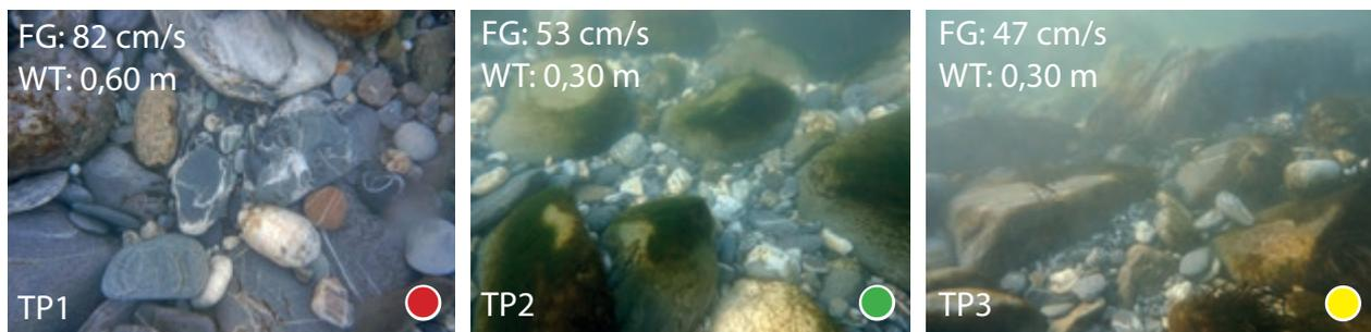
Abb. 84: Mittels UW-Sampler beprobte Teilflächen (Teilproben 1-3). TP1-3 = Teilproben; WT = Wassertiefe. Kolmationskategorien: Stufe 1 = keine Kolmation; Stufe 2 = geringe Kolmation; Stufe 3 = mittlere/mäßige Kolmation; Stufe 4 und 5 = starke und/oder äußere Kolmation. Fotos: HYDRA 2015 ©.
